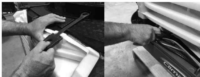
Rebranchez les montants verticaux des flexibles sur les attaches de retenue des flexibles, au niveau des chambres en mousse.
