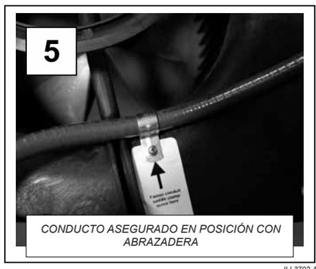
Verifique que el conducto esté libre de la polea del ventilador y el medio de la almohadilla de enfriamiento después de que la abrazadera del sillín esté asegurada.
